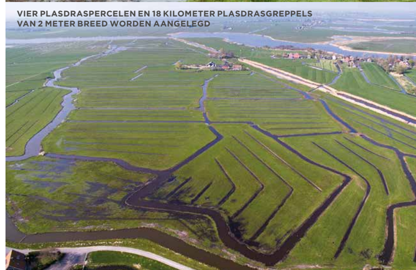
GREPPELS WORDEN VERBREED TOT 2 METER BREDE PLASDRASGREPPELS
